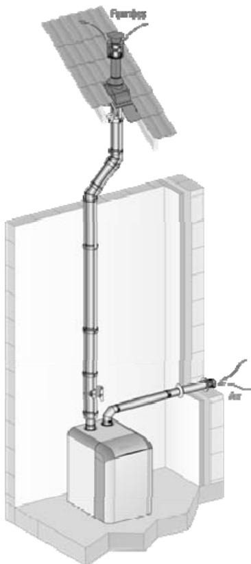
Figure 3 – Schéma de principe d'un montage DUALIS EI en configuration séparée
