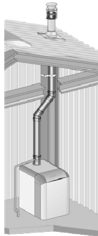
Figure 2 – Schéma de principe d'un montage DUALIS EI en configuration concentrique (terminal vertical)
